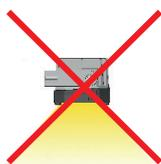
Questo genere di montaggio non è ammesso per impiego esterno (membrana).
